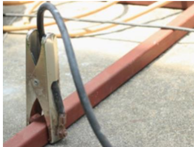
Boyalı parçaya uygulanan şaseleme işlemi.
