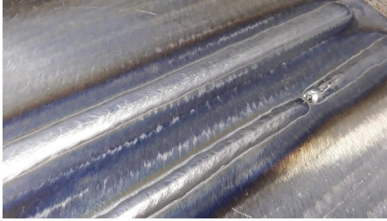
Görsel 1: 3,20 mm çapındaki tel ile yapılan kaynaklardan alınan farklı dikiş geometrileri.
